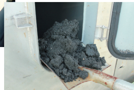
脱水された汚泥
