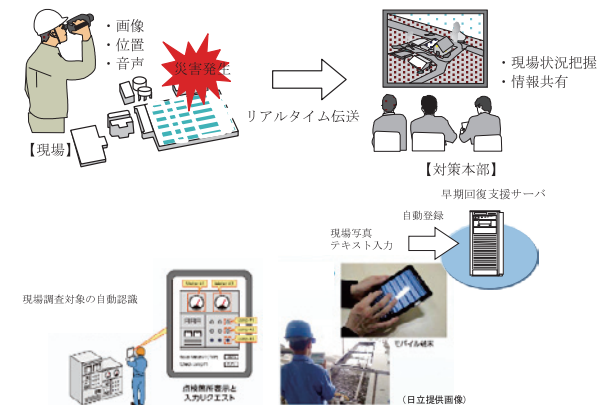
図-2 現場調査における機能例
