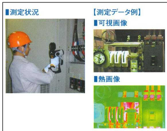
図1 局部加熱測定\*
