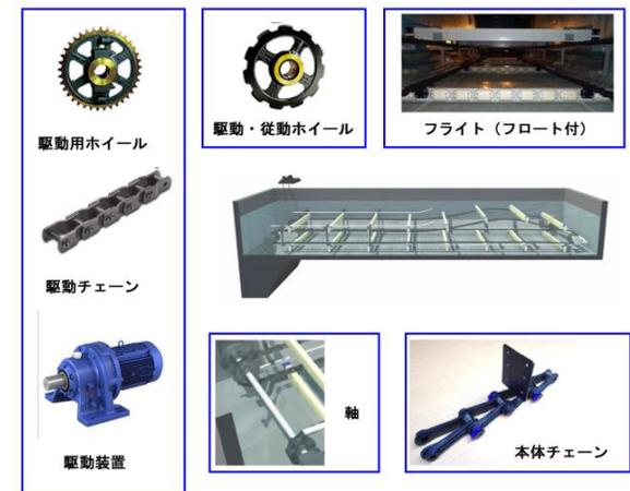
図2 浮上型汚泥かき寄せ機の構造
