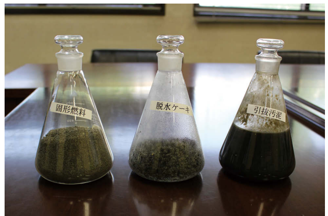
写真-4 左から、固形燃料（含水率20%）、脱水機供給汚泥（濃度3～4%程度）、脱水汚泥（含水率74%程度）
