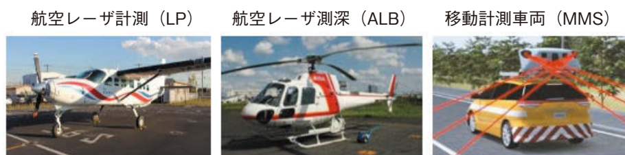
図－2 レーザ計測手法
