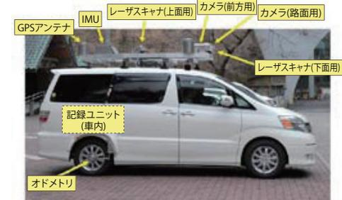
図1 GPSと連動した車載カメラ
