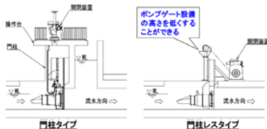
図3 門柱レスゲートを用いたコンパクト化事例
