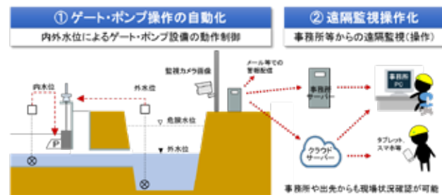
図4 ポンプゲート設備のスマート化(イメージ)
