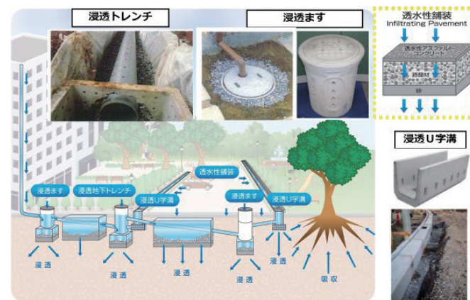
図4 雨水浸透システムの概要
