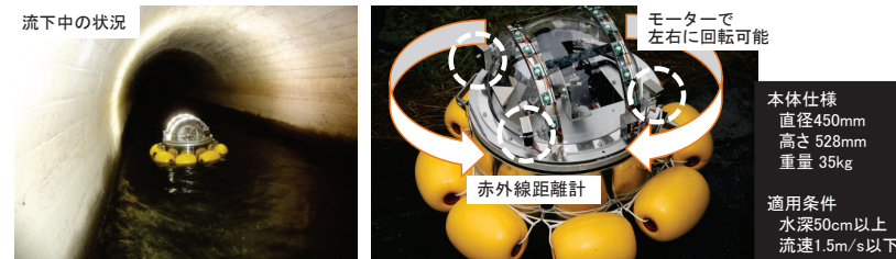
図-1 フロート型装置の外観および特徴
