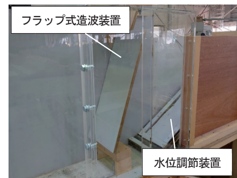
写真-4 水調整装置および造波装置
