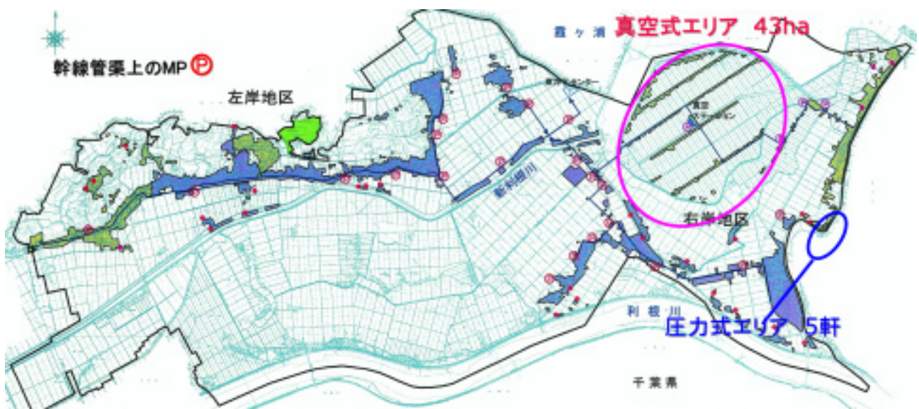
図ー2 稲敷市におけるマンホールポンプ設置状況
