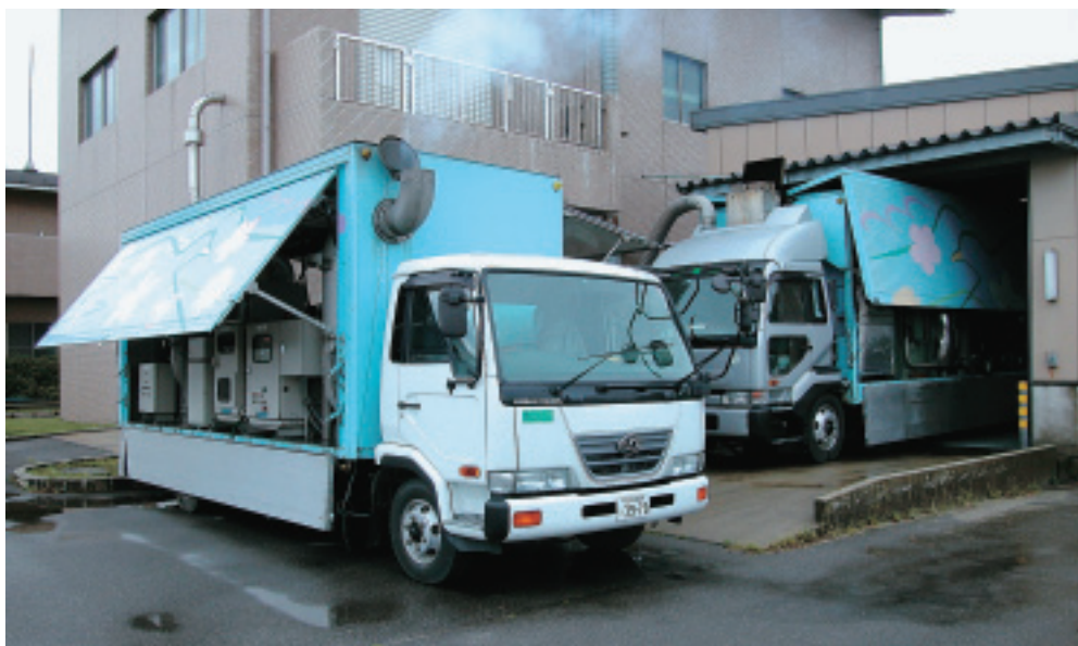
車載式高効率汚泥乾燥設備 手前は車載式電子線脱臭設備
