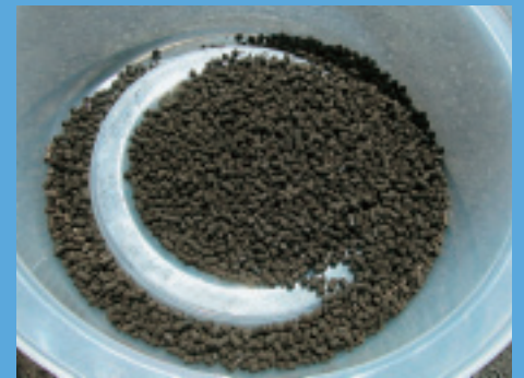
乾燥・造粒された汚泥。 肥料としてリサイクルされる
