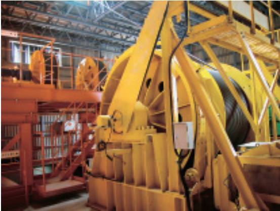
直径35.5mmのワイヤーを500m巻き上げる巨大な巻上機
