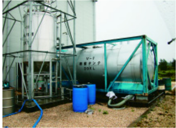
24時間ほどで発酵が進み約6%のエタノールが生成される
