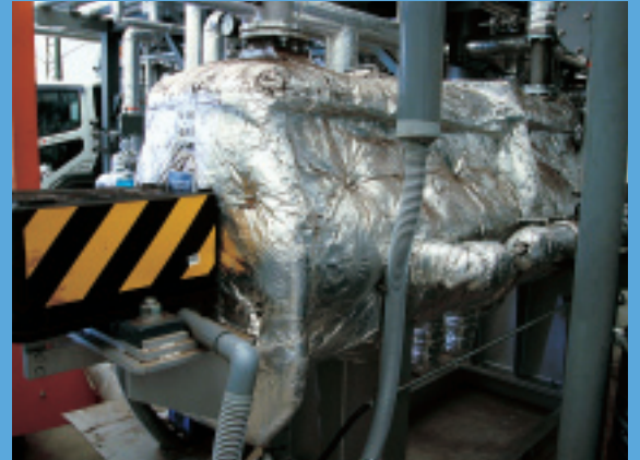
間接乾燥で含水率10%以下にする乾燥装置
