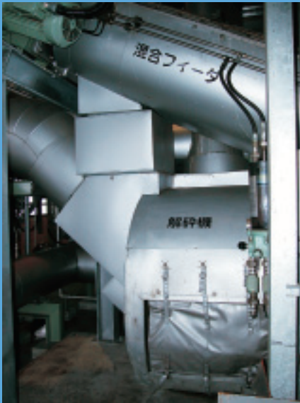
脱水汚泥と乾燥汚泥を粉碎し熱風で乾燥させる解砕機
