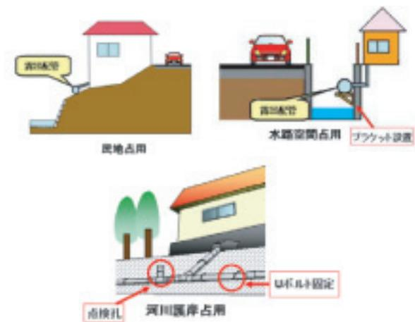
図-2 管きよの露出配管
