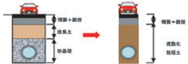
図-6 流動化処理土の管きよ施工への利用
