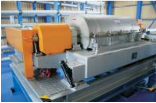
初沈汚泥と終沈汚泥を1:1の割合で混合し、デカンタで含水率93%に濃縮
