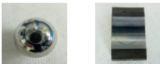
図-10 分析結果・分解した軸受
