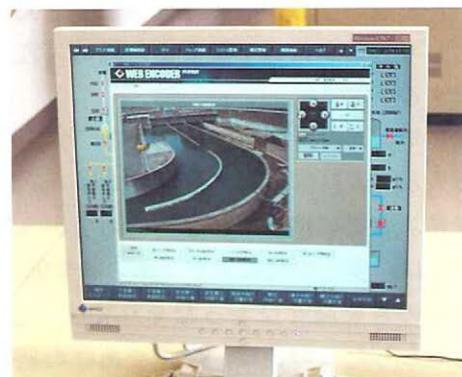
パソコンの画面で、施設の全ての監視・制御が出来る最新システムが導入されている
