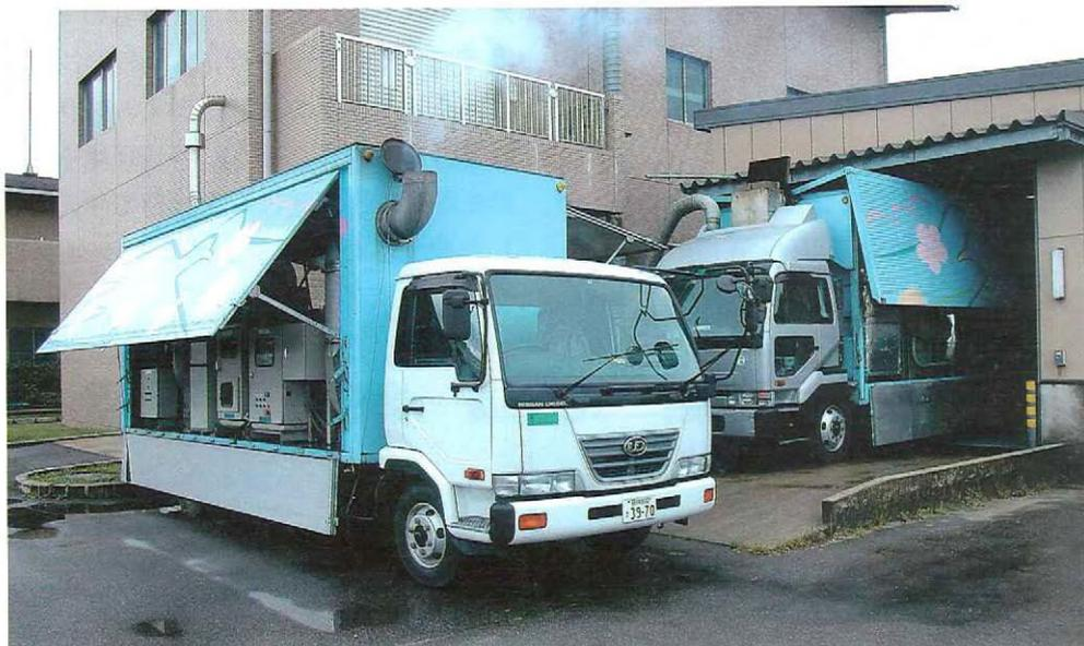
車載式高効率汚泥乾燥設備
