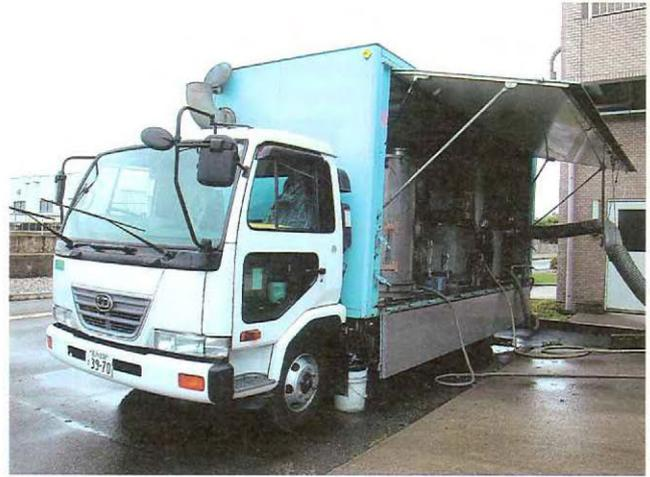
平成15年から導入された車載式電子線脱臭設備
