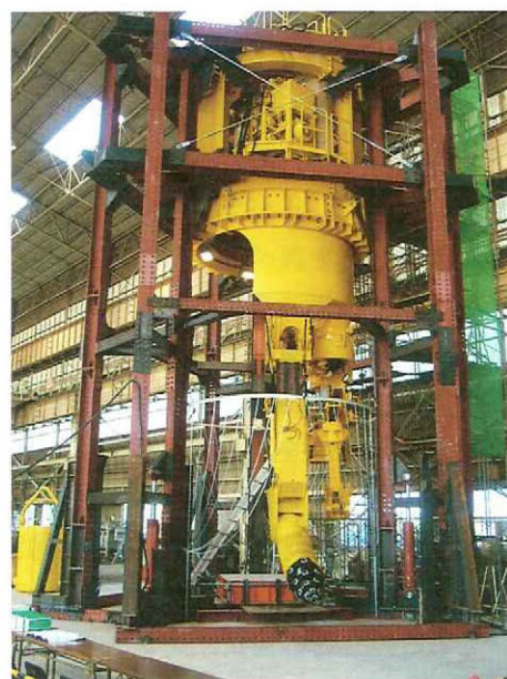
換気立坑で使用されている自由断面掘削機
