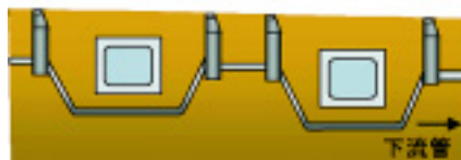
下流側が開削工法となりコスト縮減
