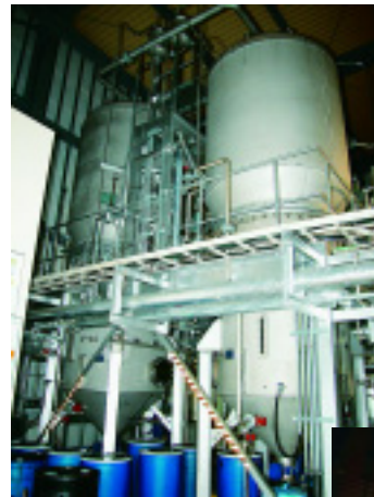
24時間ほどで発酵が進み約6%のエタノールが生成される
