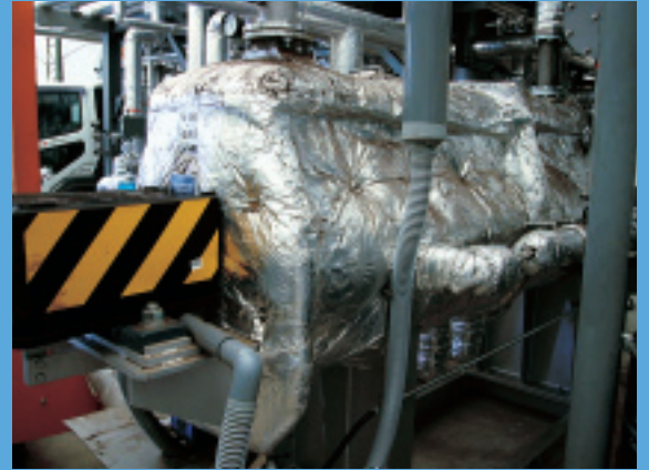
間接乾燥で含水率10%以下にする乾燥装置
