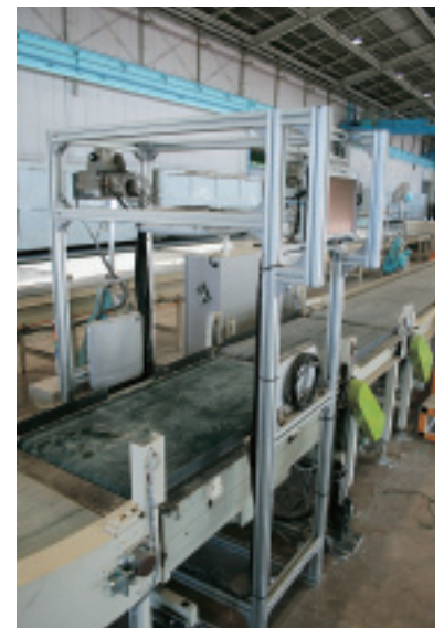
電線なども破碎し、ビニルと銅線を分けて回収
