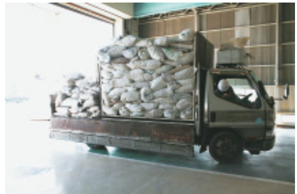
1回の巡回で15～20カ所の工事現場から廃棄物を回収する
