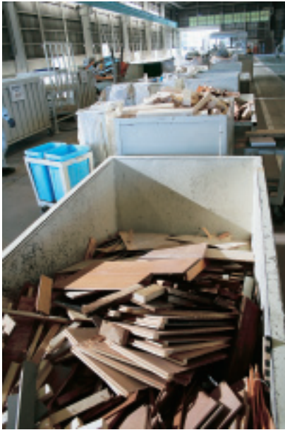
床材や天井材は破碎して固形燃料に
