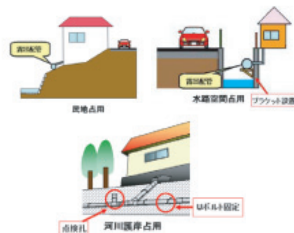
図-2 管きよの露出配管
