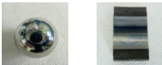
図-10 分析結果・分解した軸受
