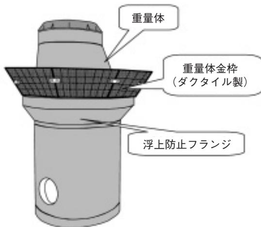
図-1 マンホールフランジ工法概要図
