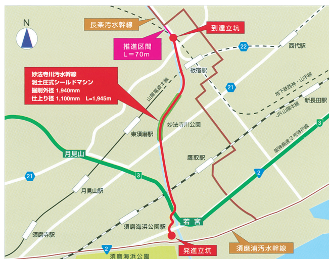
布設工事の概要
