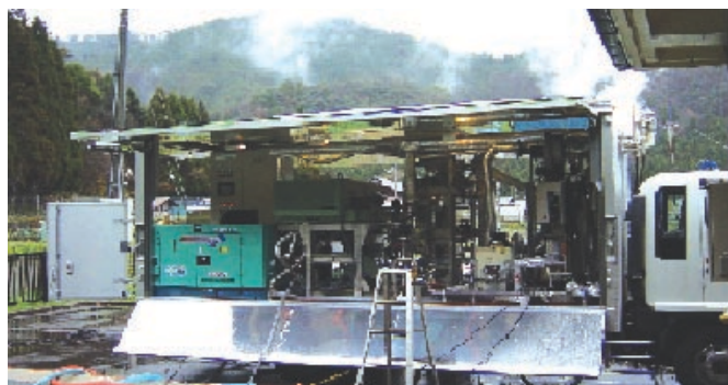
写真-1 移動式汚泥脱水乾燥車全景
