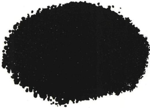
写真-1 油温乾燥汚泥
