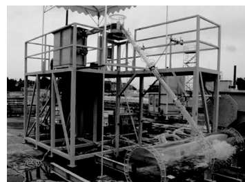
斜坑管径φ800mm, 600mm 落差20m, 角度85° 60° 45°
