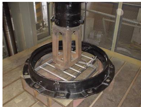
図－11 転落防止装置耐荷重試験
