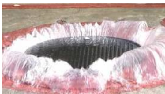
図－9 浮上試験機による圧力解放試験
