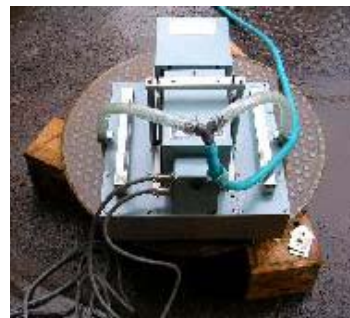
図－４ 動摩擦係数測定状況(DF テスタ R85)
