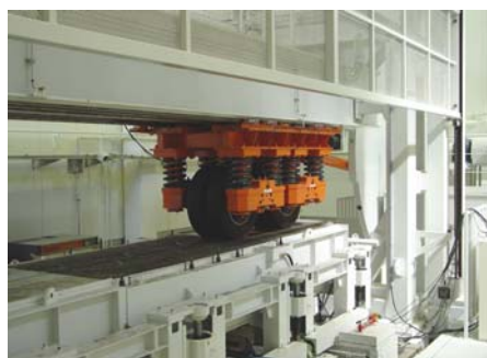
図－６ 輪荷重走行試験
