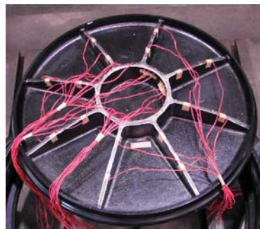
図－７ 発生応力度測定方法
