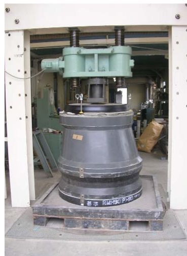
図－８ 軸方向耐圧試験
