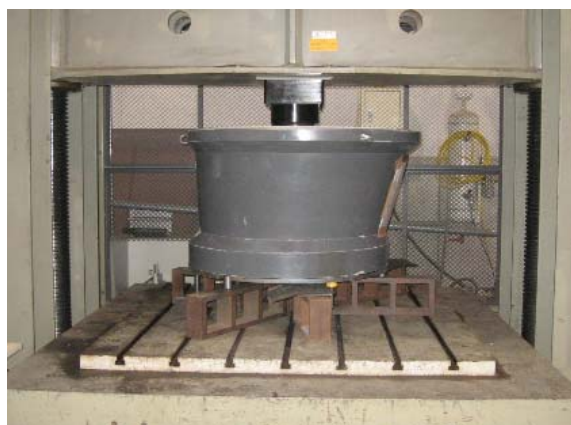
図－10 インサートナット引抜き強度試験
