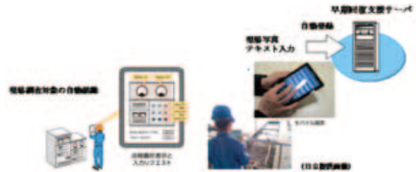
①被害把握機能の例（モバイル端末による現場調査）
