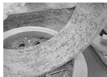
写真－1 劣化を模した供試体
