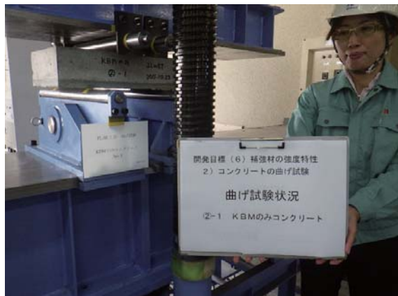
写真-2 補強材入りコンクリートの曲げ試験
