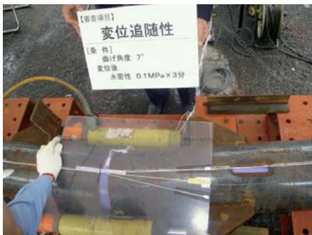
写真-2 変位追従性試験状況（曲げ角度 7°）
