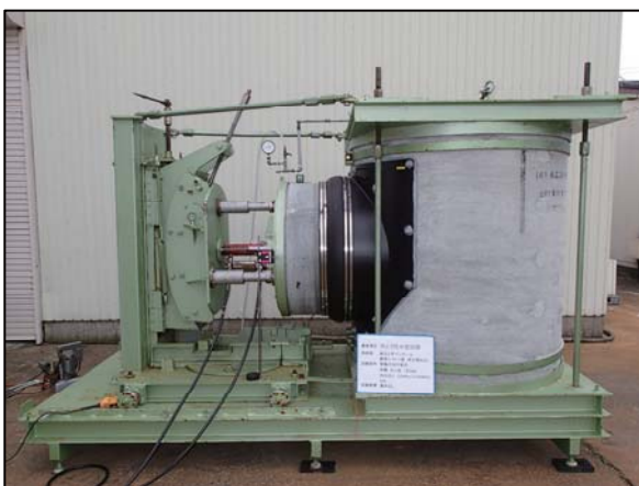
写真-3 鉛直方向の屈曲変位 上向き 1° かつ管軸方向の変位 外側 60mm 内水圧試験状況
