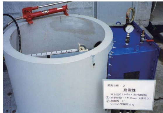
写真－３ 耐震性外水圧試験
