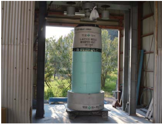
写真一七 軸方向耐圧試験状況
