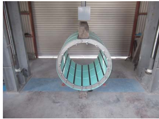
写真一八 側方曲げ試験状況
