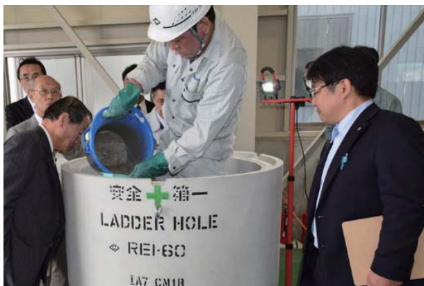
写真-5 施工性試験状況
