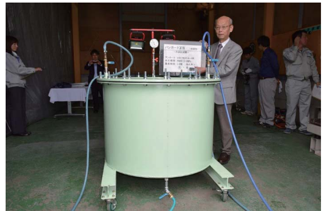
写真-6 水密試験状況
