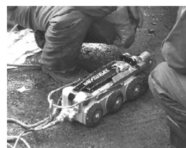
写真-2 内視鏡の精度検証 (上：自走式TVカメラ、下：内視鏡)
