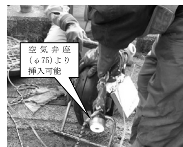
写真-3 調査対象技術 (上：自走式TVカメラ、下：内視鏡)
